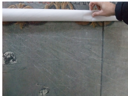
Fig. 20 : Le tracé du calque est percé de trous et prend le nom de poncif. Celui-ci est alors placé sur la surface vierge du cadran ; puis une poudre est appliquée en tamponnant sur le poncif et en entrant par les trous, la poudre de couleur va marquer la surface qui sera peinte à la main.
