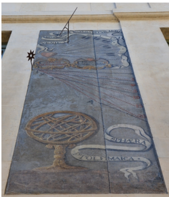
Fig. 3 : Panneau 1 avec son cadran solaire inférieur qui indique les heures planétaires en usage dans l'Antiquité avec en-dessous une sphère armillaire qui représente le système géocentrique de Ptolémée.
